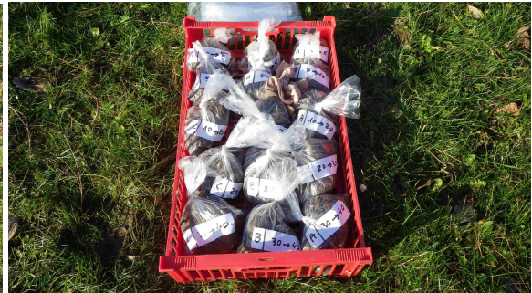
Carottages aux 3 sommets d'un triangle équilatéral et échantillons conditionnés pour le transport
