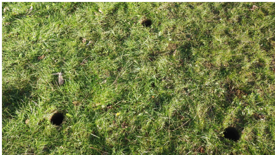
Carottages aux 3 sommets d'un triangle équilatéral et échantillons conditionnés pour le transport
